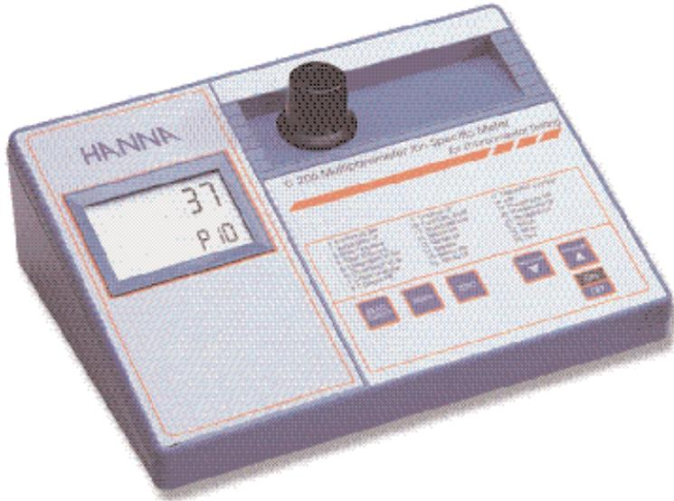
Con el **HI 83206**, se reúnen 24 parámetros de control en un único equipo compacto, de dimensiones y peso reducidos.
